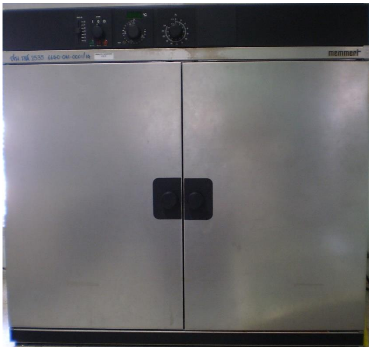
ภาพที่ ๒๐ เครื่องที่ ๒ จะเป็นตู้ขนาดใหญ่สามารถควบคุมอุณหภูมิตั้งแต่ ๓๕ ถึง ๒๐๐ องศาเซลเซียส
