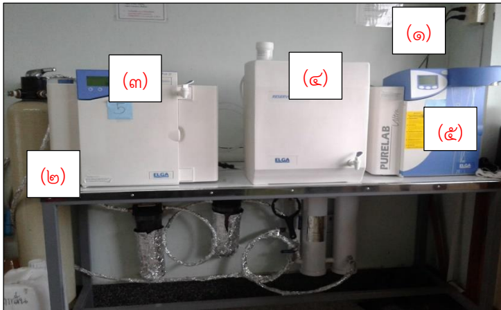
ภาพที่ ๕ แสดงเครื่องทำน้ำกลั่น ติดตั้งที่ชั้น ๕ ห้อง ๖๕๑๗/๒
